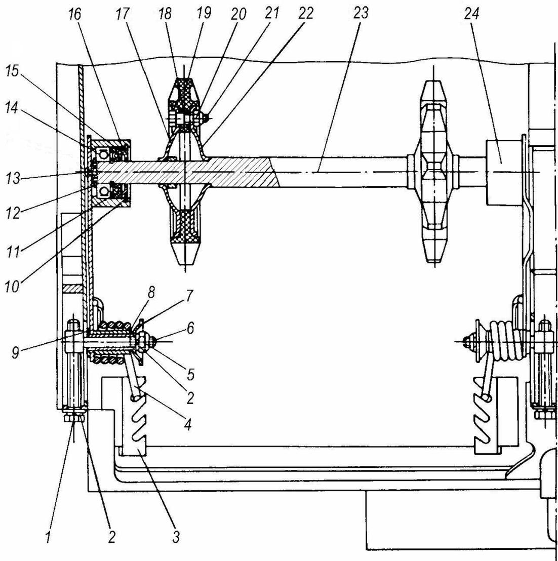
Рисунок 6 – Направляющий вал с механизмом натяжения гусениц
