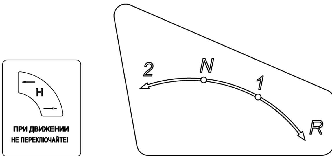
Рисунок 9 - Табличка переключения передач
