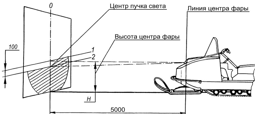
Рисунок 16 – Регулировка фары
