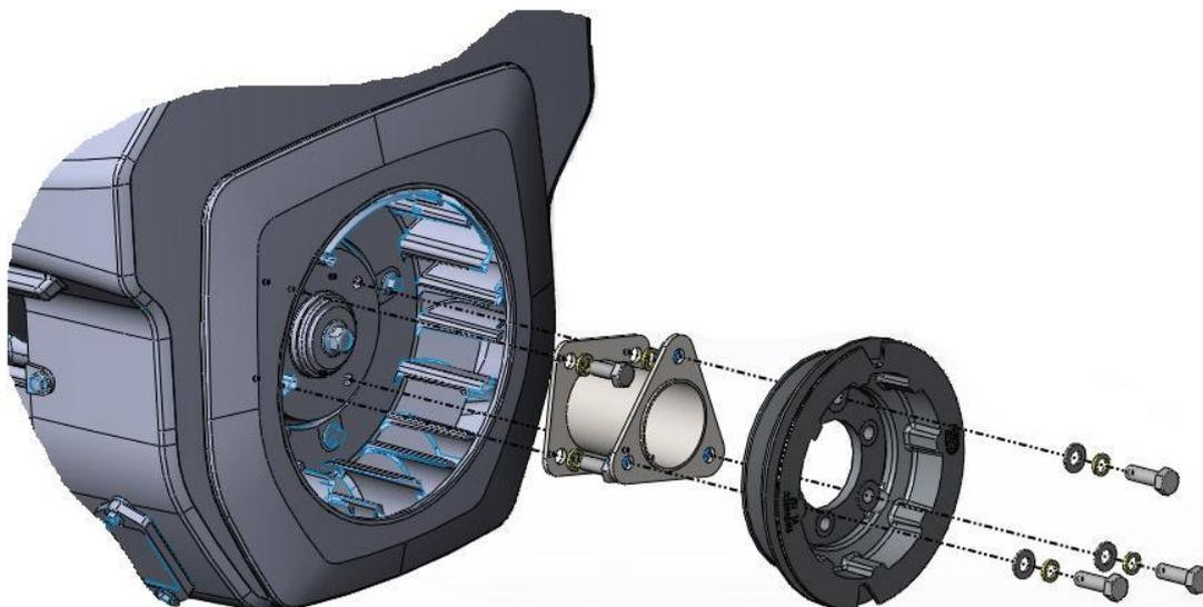
Рисунок 11 - Схема установки аварийного запуска KOHLER.
